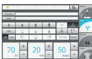
Controle do gerador
